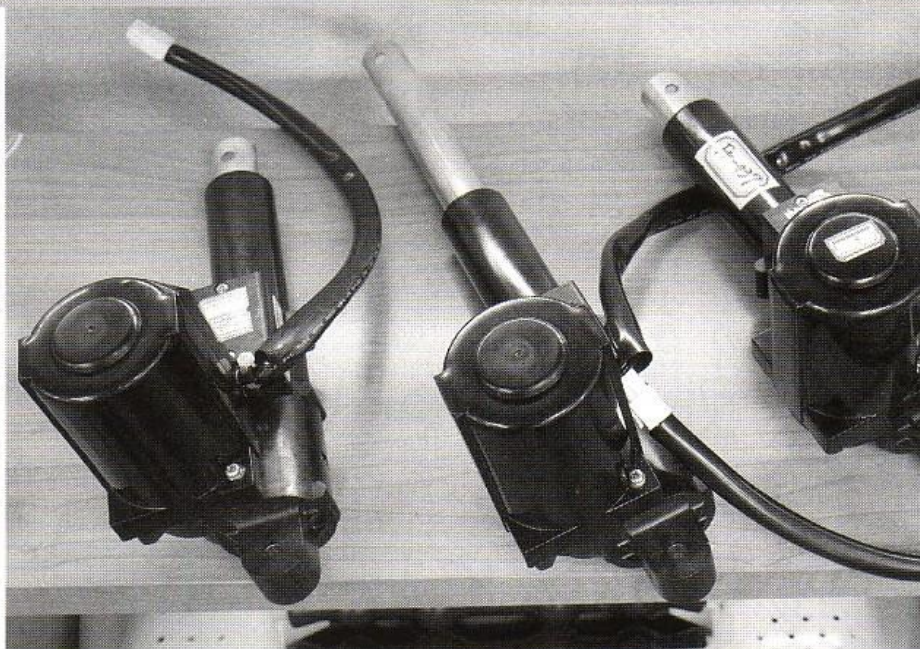
アクチュエーター。たとえばマッサージチェアでは、リクライニング部分やローラー調節部分など、複数の場所で使われている
